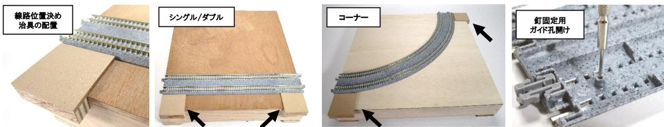
図のように線路位置決め治具で線路を配置し、お好みの方法で線路をボードに固定してください。
