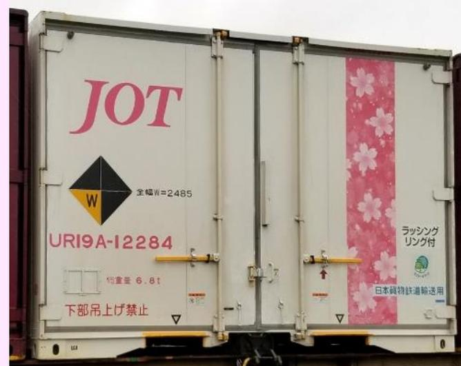
UR19Aコンテナは、両側面の扉が開く冷蔵コンテナです。日本石油輸送 (JOT) が所有する同形式のうち、最近新製されたコンテナは「和」をイメージした、華やかな桜模様の帯が入ります。
