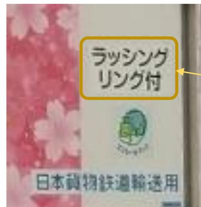
桜の模様入りの帯が入るコンテナは、内部に荷物固定用のラッシングリング付に改良され、コンテナ側面に「ラッシングリング付」の表記があります。
